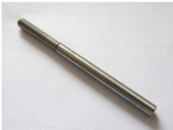
Wellenendstück mit M5-Gewinde und Bohrung für 3,2mm Flexwellen sowie eingefräster Phase zum Verschrauben eines DogDrive-Adapters.
