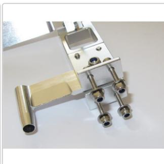
Aluminium Ruderanlage, silber eloxiert. Gelenk sintergelagert, Ruderblatt mit Wasserkühleinlass. Ruderhorn auf beiden Seiten. Natürlich mit Klappmechanismus - sollte mal ein Ast überfahren werden.
