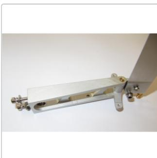
Aluminium Ruderanlage, Gelenk sintergelagert, Ruderblatt mit Wasserkühleinlass.
