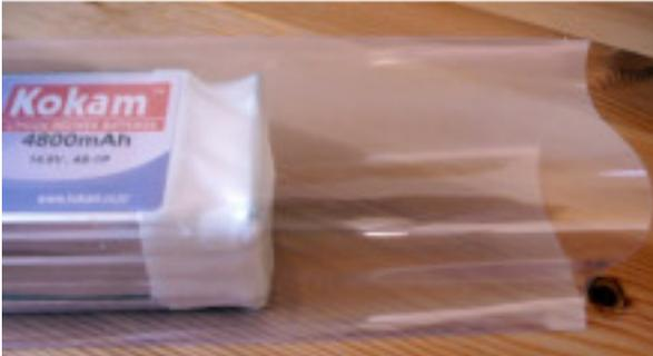
Schrumpfschlauch für LiPo-Packs oder auch inlineverlötete SubC-Zellen.
