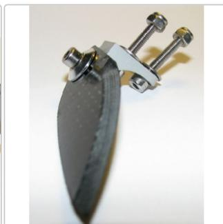
Set aus verstellbaren Alu/Carbonturnfins als kompletter Montagesatz.
