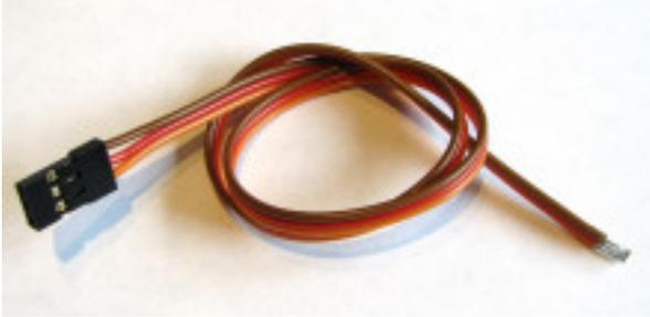
Servo-Anschlusskabel Typ "Uni / JR" mit vergoldeten Steckkontakten. Litzenenden verzinnt. Kabelquerschnitt 3x0,25qmm.
