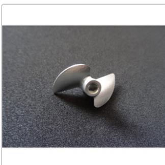
32mm 2-blatt Aluminiumpropeller mit Steigung 1.4 und M4 Gewinde.
