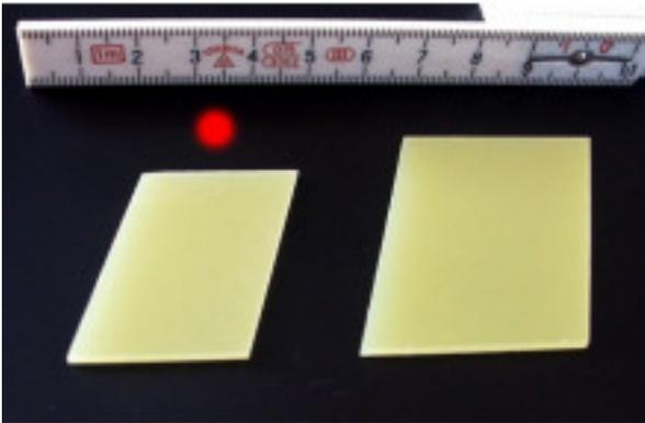
Turnfinrohling Größe 1 für Micro-Hydro, Mini-Hydro und auch Hydro 1 Boote. CNC gefrästes GFK Plattenmaterial mit 1,6mm Stärke.
