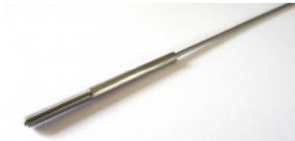
Gerichtete 2mm Federstahlwelle mit fertig verklebtem (Loctite) 4mm V2A-Endstück (Made in Germany). Welle dabei über die gesamte Länge des Endstücks verklebt.
