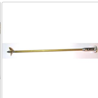
Hochwertige Kompaktwellenanlage, gleitgelagert und mit variabler Länge und DogDrive für 4mm. Auch 3/16" Zoll Propeller (Graupner K-Serie) lassen sich mit einem Distanzröhrchen montieren. Anlage kommt inklusive Kupplung 5mm auf 4mm. Passend für alle Motoren mit 25m Lochkreis und 5mm Welle, wie zum Beispiel die Leopard LBP36- oder LBP40-Reihe
