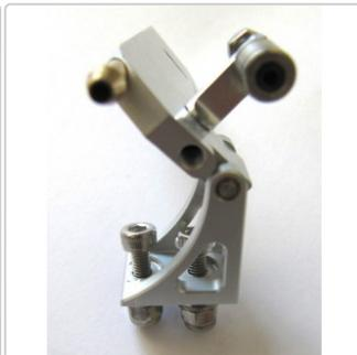
Aluminium Ruderanlage, Gelenk sintergelagert, Ruderblatt mit Wasserkühleinlass.
